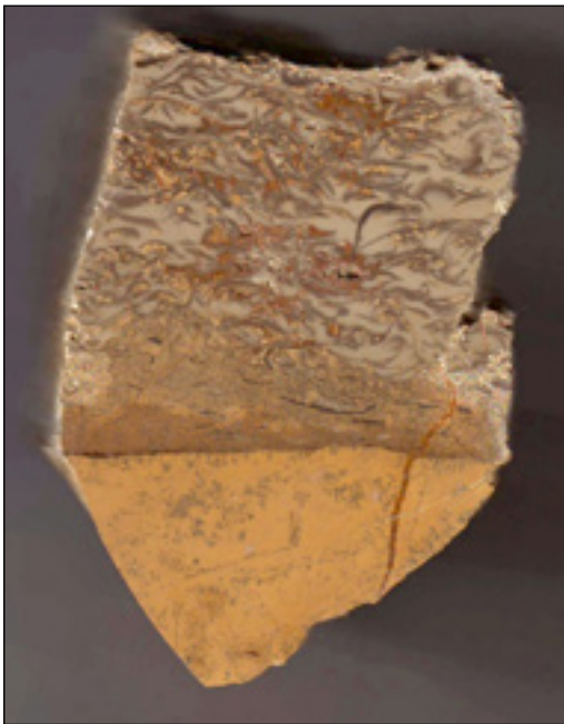
Abb. 1: Muschelkalk mit deutlicher Grenze Zyklus 1, Phase E: Gelbkalk im Liegenden, gegen Zyklus 2, Phase A im Hangenden. Abmessungen der Gesteinsprobe: 10 cm hoch, 7 cm breit
