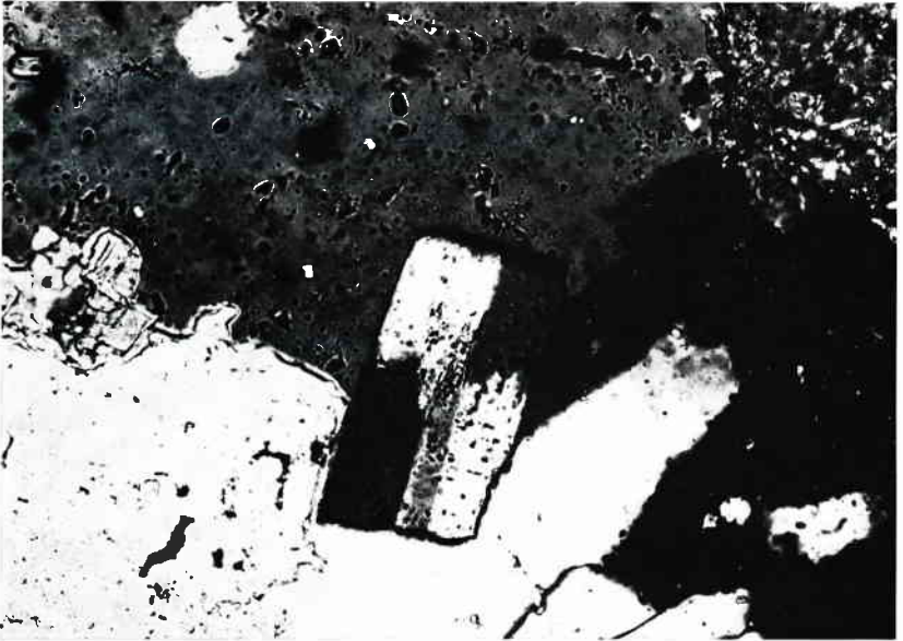
Abb. 32: Mikroskopische Aufnahme eines Dünnschliffs: Durchkreuzungsverzwilligung an einem Feldspat. Neubildung in einem Quarz-Calcit-Aggregat, Steinmergelkeuper (km 4), Extertal. Polarisiertes Licht mit Analysator (= gekreuzte Polarisatoren). Bildausschnitt: 0,36 x 0,24 mm
