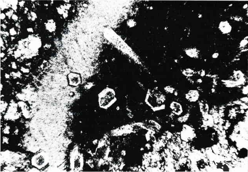
Abb. 7: Mikroskopische Aufnahme eines Dünnschliffs, Oberer Muschelkalk vom Gret-Berg, „Terebratelkalk“. Quarz-Neubildungen im Steinkern und in der Schalensubstanz von Coenothyris . Polarisiertes Licht ohne Analysator. Bildausschnitt: 2,6 x 1,7 mm
