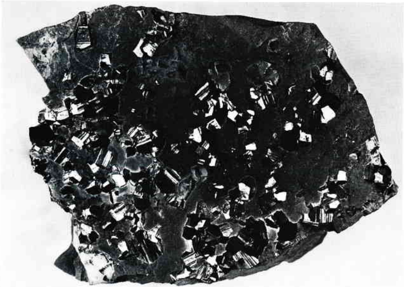
Abb. 22: Pyrit-Anreicherung auf Schichtfläche im Steinmergelkeuper (km 4), Extertal. Abmessung der Probe: 80 x 62 mm.
