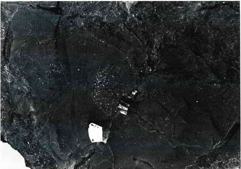
Abb. 20: Pyrit, auskristallisiert an tektonisch bedingten Klüften, Rissen und Drucksuturen. Steinmergelkeuper (km 4), Extertal. Bildausschnitt: 40 x 28 mm
