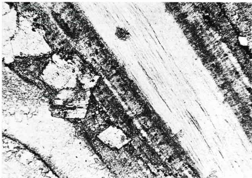
Abb. 5: Mikroskopische Aufnahme eines Dünnschliffs: Trochitenkalk außerhalb der tektonischen Brekzie von Oeynhausen. Einzelne Carbonat-Rhomboeder in der ooidartigen Umhüllungssubstanz einer hier fast gerade gestreckt erscheinenden Coenothyris -Klappe (= Terebratula ). Die Klappe verläuft durch die rechte Bildhälfte, links unten liegt ein Muschelrest. Polarisiertes Licht ohne Analysator. Bildausschnitt: 0,85 x 0,6 mm.
