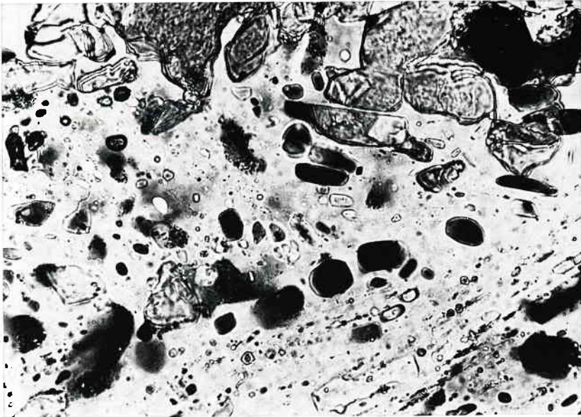
Abb. 1: Mikroskopische Aufnahme eines Dünnschliffs: Calcit (im oberen Abbildungsteil: grau), Anhydrit, z. T. idiomorph, rechteckig erscheinend, z. T. stark gerundet (in Auslöschungstellung liegende Individuen erscheinen schwarz), weißliche Grundmasse: Gips. — Gips-Aggregat aus den Unteren bunten Mergeln (km 1) der Saalegge (Blatt Vlotho). — Polarisiertes Licht mit Analysator (= gekreuzte Polarisatoren). Bildausschnitt: 0,34 x 0,24 mm.
