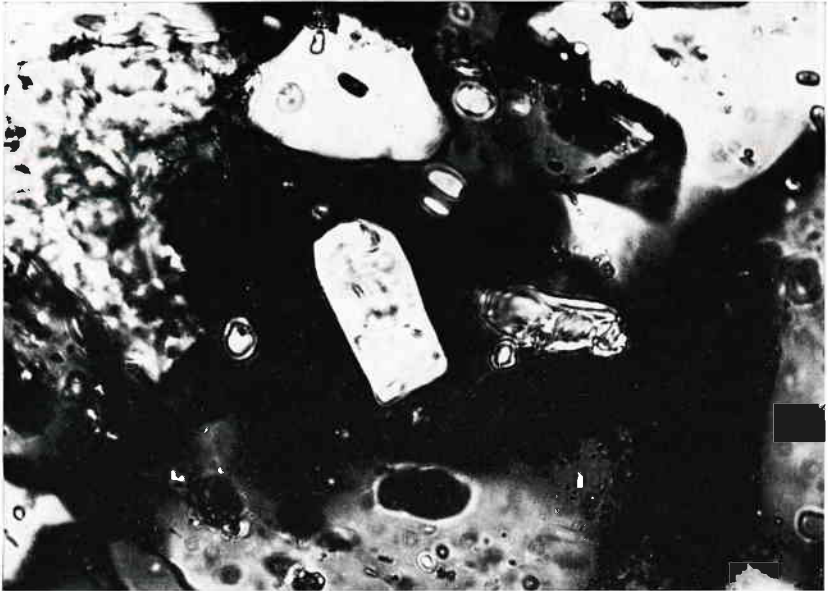
Abb. 2: Mikroskopische Aufnahme eines Dünnschliffs: Anhydrit-Individuum, fast idiomorph, rechteckig (in Bildmitte) in einem Quarz-Calcit-Gemenge. (Der Quarz in Auslöschungsstellung erscheint schwarz.) — Quarz-Calcit-Aggregat aus den Unteren bunten Mergeln (km 1) der Saalegge (Bl. Vlotho). — Polarisiertes Licht mit Analysator (= gekreuzte Polarisatoren). Bildausschnitt: 0,17 x 0,12 mm.
