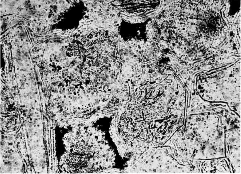
Abb. 32: Mikroskopische Aufnahme eines Dünnschliffs: Tertiärquarzit, Fundort: Lenderscheid. Am linken Bildrand wird ein Anwachssaum aus Quarz von einem benachbarten Korn durchstoßen. Drucklösung erfolgte in einem Stadium nach Regenerierung primärer Sandkörner. Zusätzlich werden fasrige Chalcedon-Beläge und von Ton erfüllte Poren sichtbar. Polarisiertes Licht ohne Analysator. Bildausschnitt: 0,34 \times 0,24 mm.
