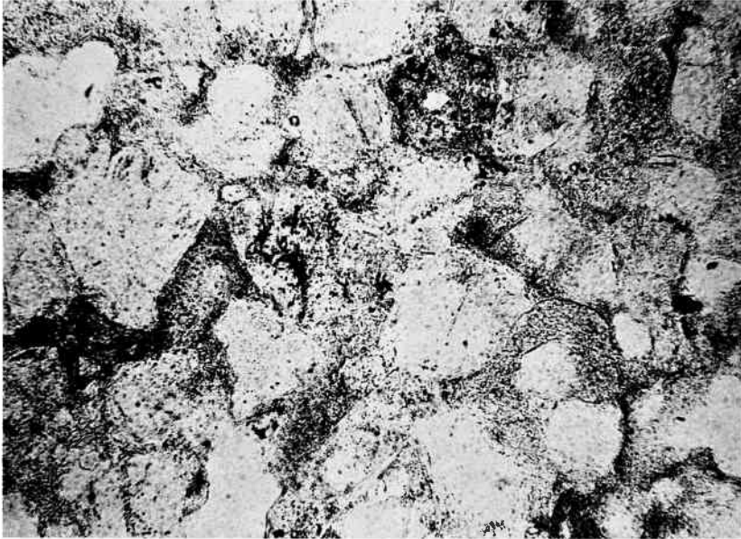
Abb. 38: Mikroskopische Aufnahme eines Dünnschliffs: Bruchstück einer Platte vermutlich aus Osningsandstein (Unterkreide, Teutoburger Wald). Belegstück: Stukenbrock – W, 1783 a. Das Gemenge besteht vorwiegend aus Quarzsandkörnern und Carbonat-Aggregaten [Fossilgrus], das Bindemittel aus feinen Chalcedon-Ausscheidungen. Polarisiertes Licht ohne Analysator. Bildausschnitt: 0,8 × 0,6 mm.
