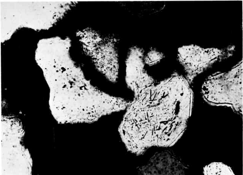
Abb. 33: Gleiche Aufnahme bei Anwendung polarisierten Lichtes mit Analysator (= gekreuzte Polarisatoren). Tertiärquarzit, Fundort: Lenderscheid. Im Quarzkorn auf der rechten Bildhälfte werden Einschlüsse nadeligen Rutilen sichtbar.
