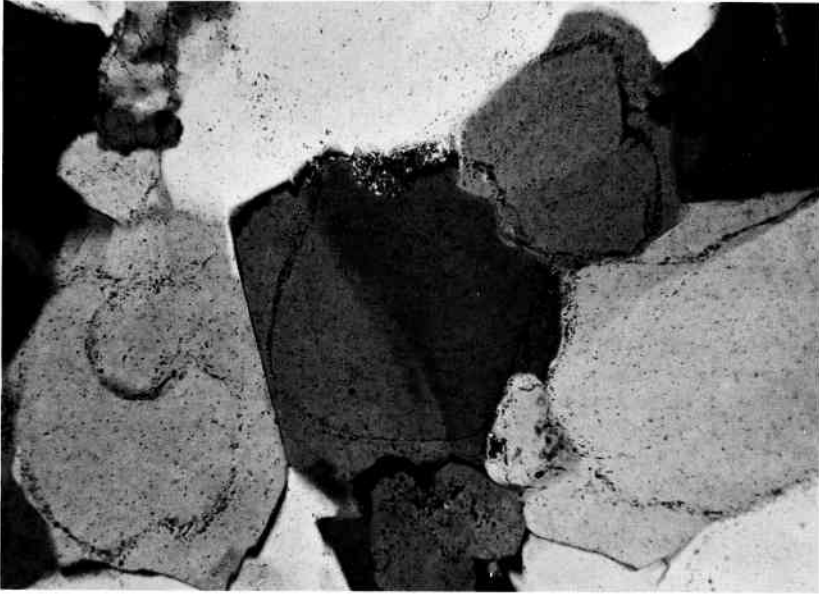
Abb. 5: Mikroskopische Aufnahme eines Dünnschliffs: Nordischer Quarzit mit Umrissen der primären Sandkörner, mit Anwachssäumen aus Quarz und grubenförmig (links), bzw. unruhig verlaufenden Drucklösungserscheinungen (Mitte, ob. Bild-drittel), die vor der allgemeinen Einkieselung entstanden sind. Belegstück Stukenbrock – FW 14.336. Polarisiertes Licht mit Analysator (= zwei Polarisatoren, nicht exakt gekreuzt). Bildausschnitt: 0,8 \times 0,6 mm.
