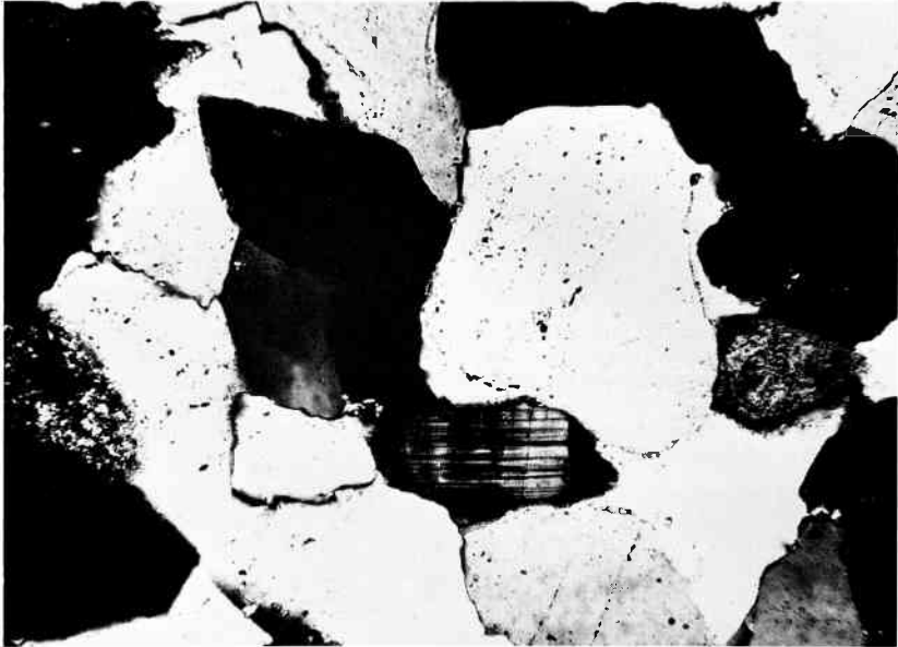
Abb. 22: Gleiche Aufnahme bei Anwendung polarisierten Lichtes mit Analysator (= gekreuzte Polarisatoren). Der Kalknatronfeldspat (Mitte, unteres Bilddrittel) zeigt eine Zwillingslamellierung nach dem Albitgesetz (vorherrschend) und nach dem Periklingesetz. Der Kalifeldspat liegt in Auslöschungsstellung und erscheint daher schwarz.
