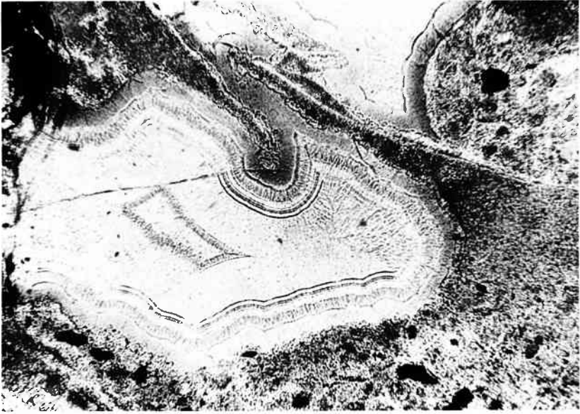
Abb. 62: Mikroskopische Aufnahme eines Dünnschliffs: Chalcedon-Füllung in Hohlräumen eines verkieselten Muschelkalk-Konglomerats. Fundort: Geröll in den Arvernensis-Schottern der Kiesgrube EHR SAM, Sülzfeld, Kr. Meiningen, 1949. Polarisiertes Licht ohne Analysator. Bildausschnitt: 2,4 \times 1,7 mm.
