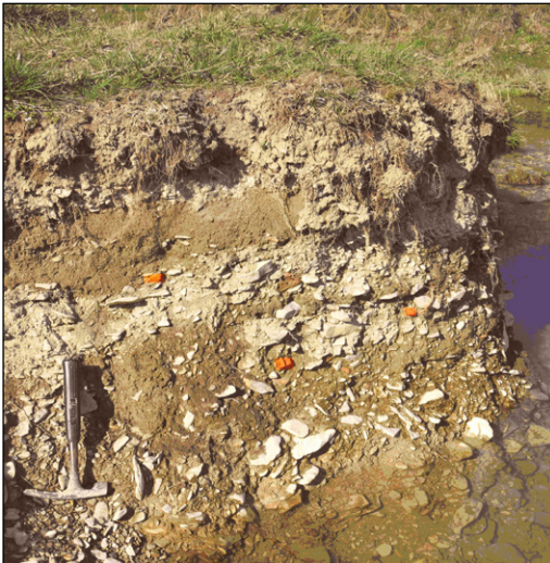
Abb. 13: Auenterrasse der Pöppelsche bestehend aus Plänerschottern und kiesführenden Lehmlagen mit einzelnen Bruchstücken von Ziegelsteinen, Ton- und Glasscherben sowie Schlackenresten ( R 34 58 120, H 57 20 350, TK 4316)
