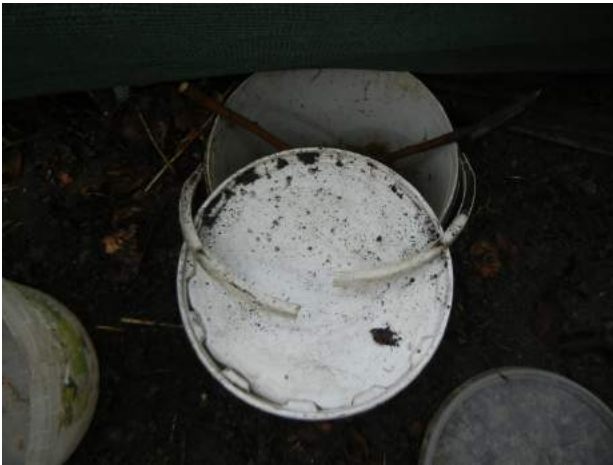
Ein solcher Henkel kann seinen Zweck, den Deckel zu fixieren, nicht erfüllen!
