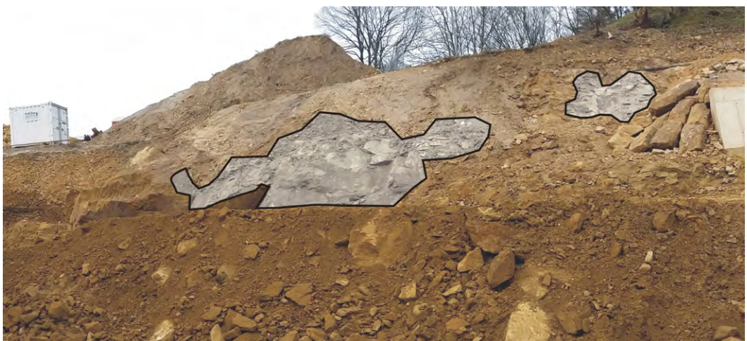
Abb. 23: Zentraler Teil der Aufschlusswand, Blick nach NE. Schraffierte Flächen markieren die aufgeschlossene große abschiebende Harnischfläche.
