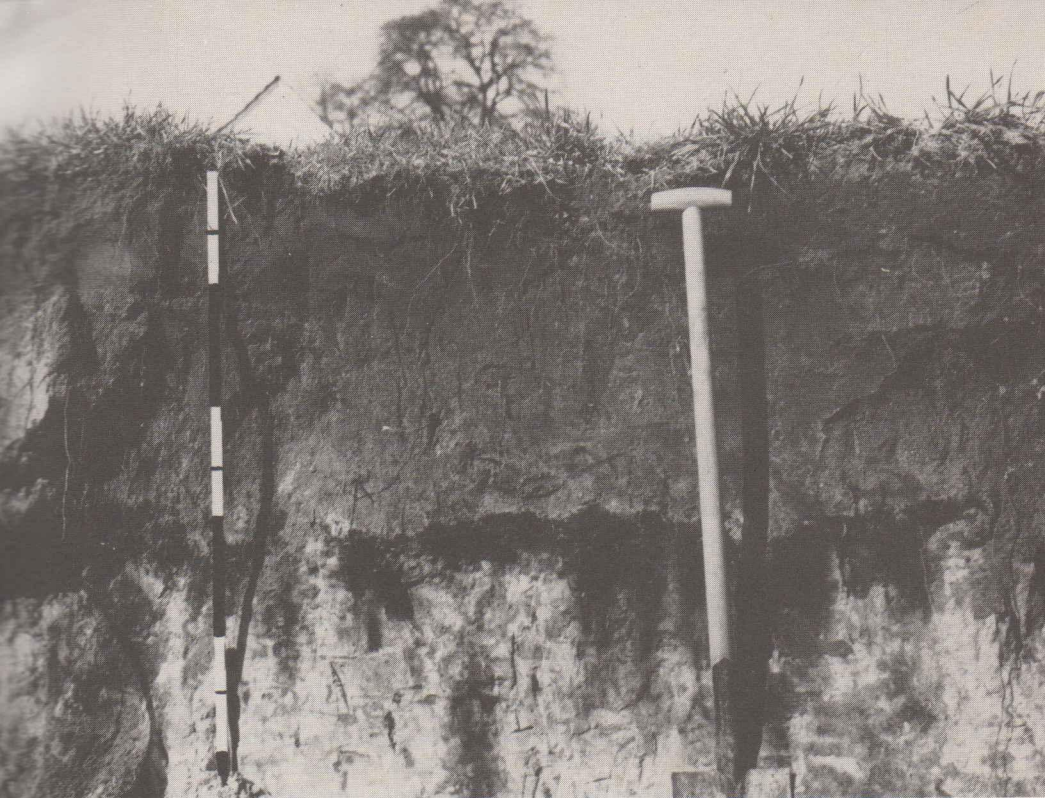
Abbildung 5: Grauer Plaggengesetz, 60 cm stark, auf B-Horizont eines Podsols; Augustdorf. Aufn.: E. Th. Seraphim, April 1980
