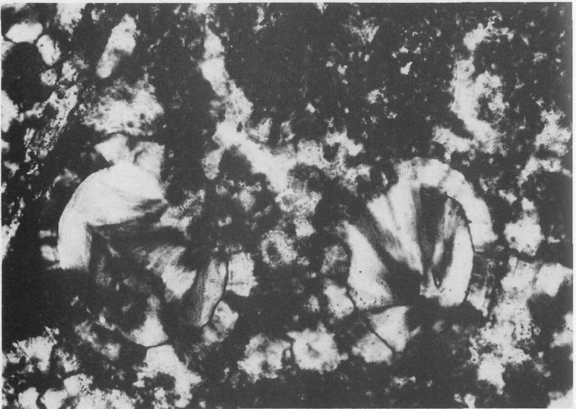
Abb. 68: Gleiche Aufnahme bei Anwendung polarisierten Lichtes mit Analysator (= gekreuzte Polarisatoren): Wände z. T. Chalcedon, z. T. Quarzin. Zentralteil besteht aus Quarzin-Fasern. Spiculit vom Haß-Berg bei Großdornberg. Bildausschnitt: 0,34 x 0,24 mm.
