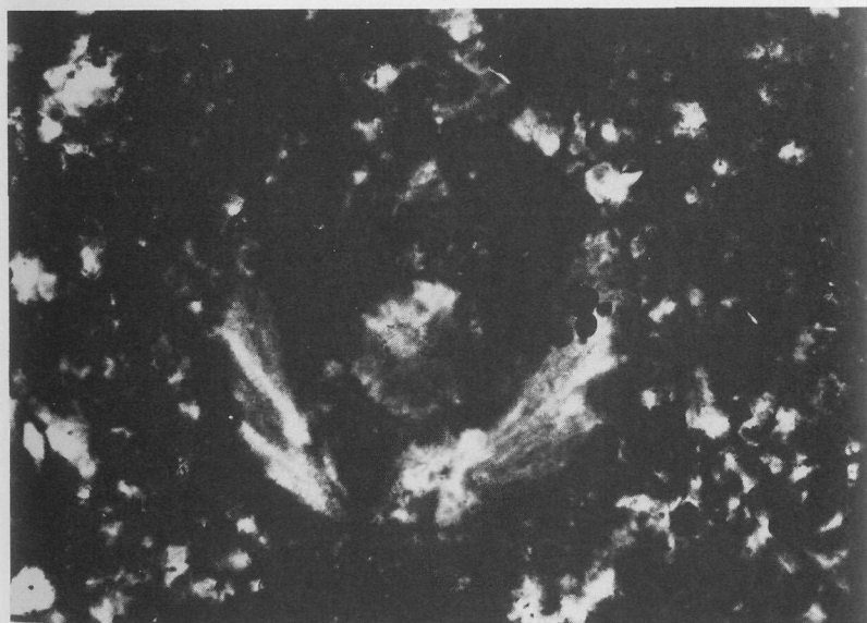
Abb. 37: Gleiche Aufnahme bei Anwendung polarisierten Lichtes mit Analysator (= gekreuzte Polarisatoren). Zweischalige Radiolarie im Kulm-Lydit. Chalcodon-Sphärolith im Steinkern. Sein Zentrum sitzt randlich. Bildausschnitt: 0,34 x 0,24 mm.
