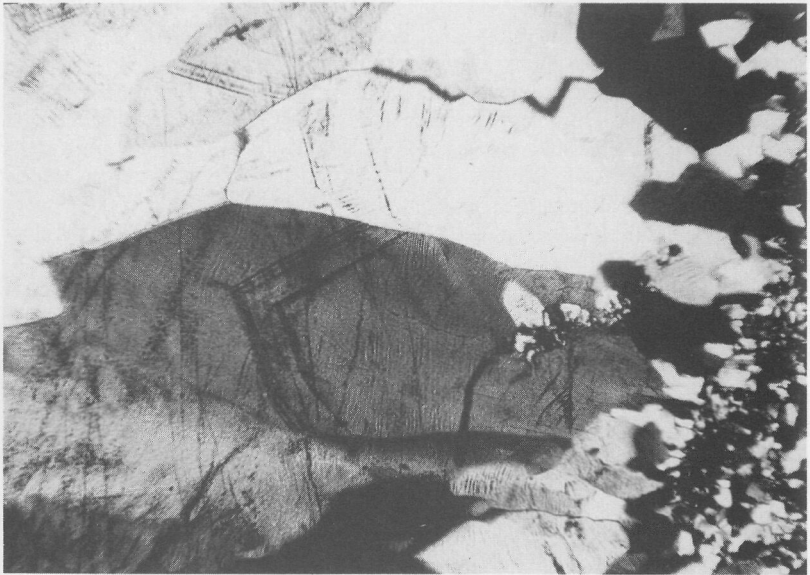
Abb. 80: Mikroskopische Aufnahme eines Dünnschliffs: Pigmentfreie grobe Kluft-Quarze im kulmischen Eisenkiesel. Fundort: Hundsdorf bei Bad Wildungen. Polarisiertes Licht mit Analysator (= gekreuzte Polarisatoren). Bildausschnitt: 2,4 x 1,7 mm.
